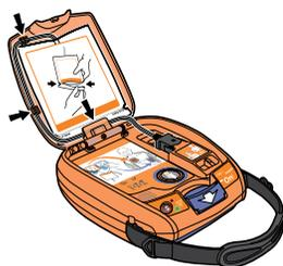
Passo o cabo pelas três guias de cabos de cabos da parte de trás da tampa. (Indicado com setas na ilustração)
