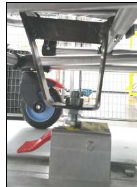
Figura 09 – Sistema de fixação traseiro
