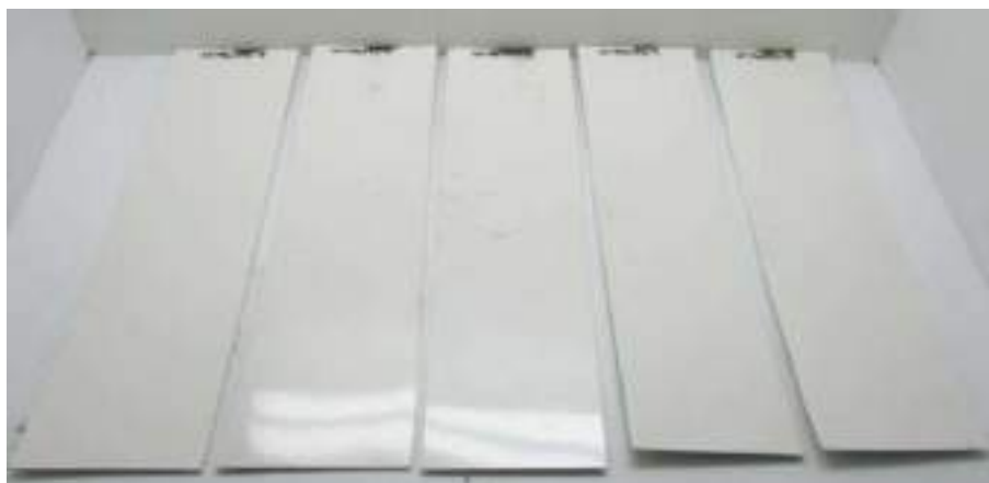
Figura 3: Corpos de prova após ensaio de inflamabilidade – NT196045.
