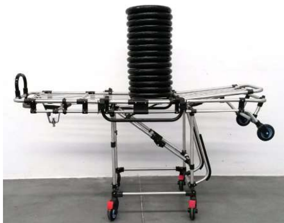
Figura 05 – 300 kg de carga centralizada
