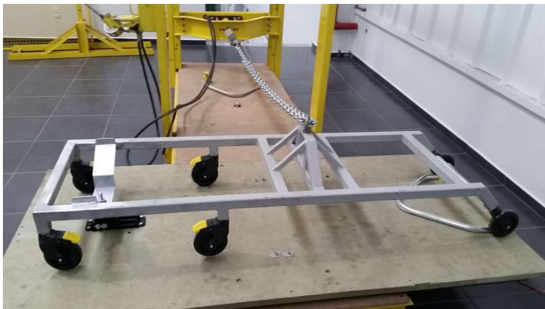
Foto 07-Aplicação de carga no sentido lateral
