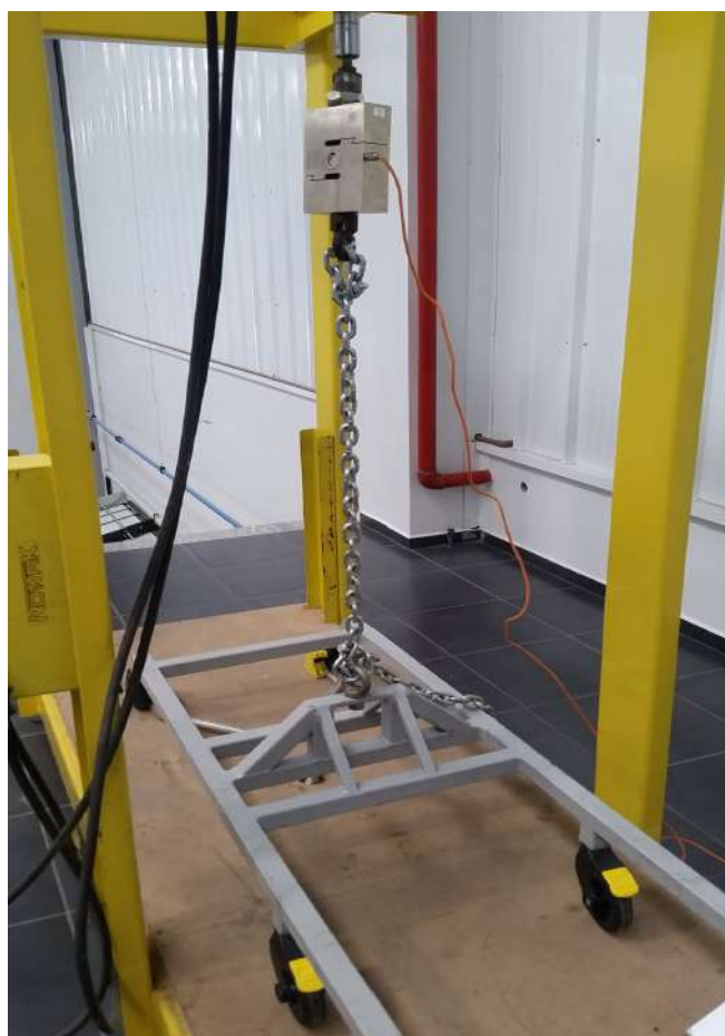
Foto 06 - Aplicação de carga no sentido vertical
