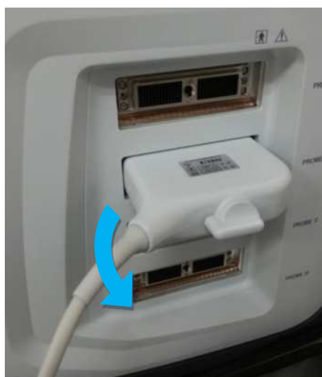
Fig.4-7 Desligando o Conector do transdutor
