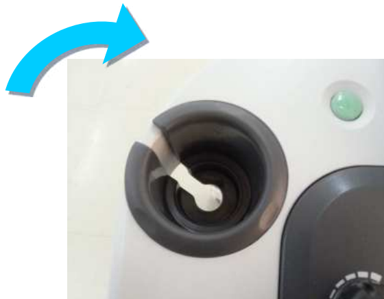
Fig.4-8 Gire o suporte do transdutor no sentido horário
