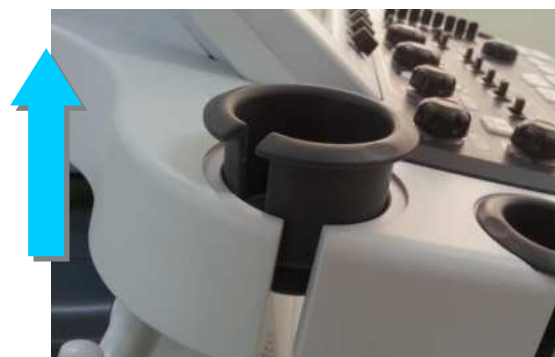
Fig.4-9 Levante o suporte do transdutor
